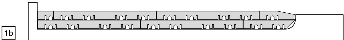
Der Fliesenboden in der Duschwanne kann auch nach oben hin angepasst werden. Dann wird eine Rampe gelegt, deren Höhe dem Boden angepasst wird.
